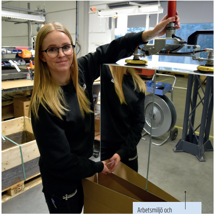
Arbetsmiljö och ergonomi hör till den sociala hållbarheten hos Gårö. Nathalie Cedergren packar Gårö Badrumsskåp med den nya lyftarmen.
